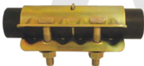
MI-011 SLEEVE COUPLER For Pipe OD 48.3 mm (EN -74 / BS -1139)
